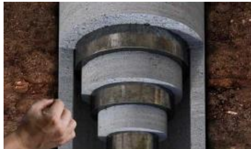
Odwiert po cementowaniu
