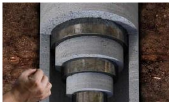
Rysunek 3. Odwiert po cementowaniu.
